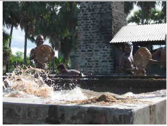
写真-8 小規模精米業者におけるパーボイル処理 小規模な精米業者では、人力によりパーボイル処理を行っている。
