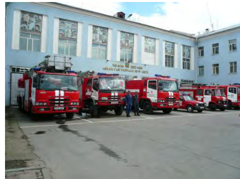
UB 市消防局の第 10 消防署に配備されている 2003 年供与車両。左から、はしご車、4,000L 水槽付消防車、8,000L 水槽車。
