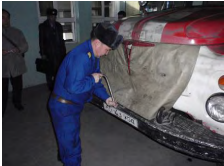
セルモーターが故障し、クランクシャフトを手で廻して、エンジンを始動させる。
