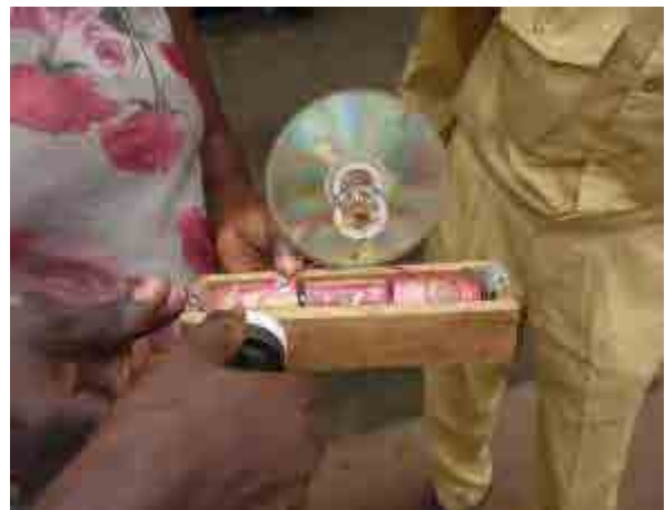
未電化家屋で使用されている LED ランプ
