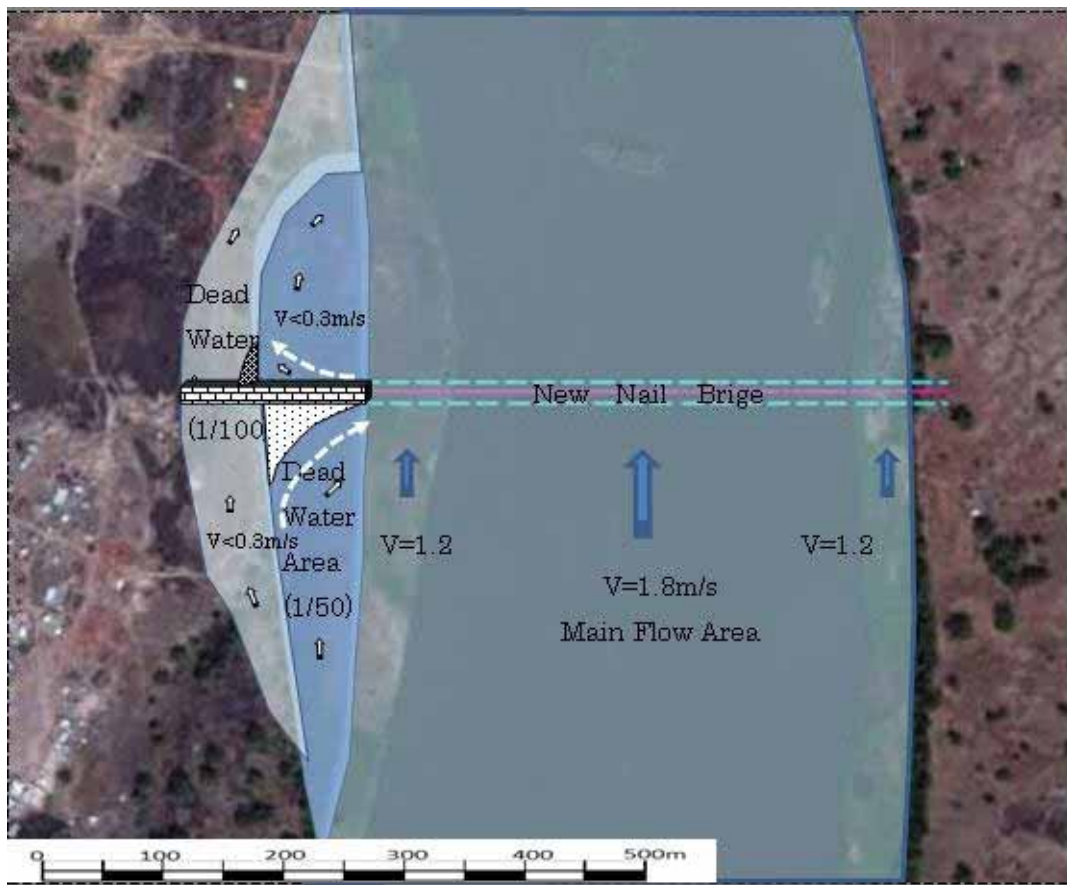
図資 8-8 高水敷に橋台を設置した場合の影響想定図
