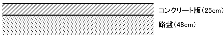
図 3-2-9 取付道路(1)の舗装構造
