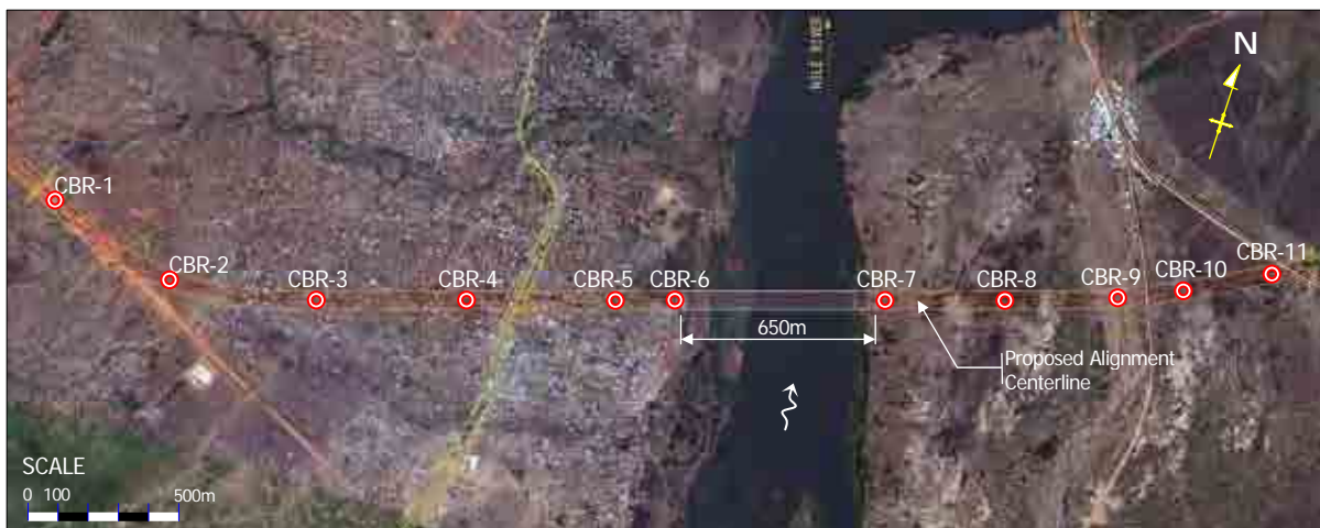
図資 6-2 アプローチ道路の CBR 試験位置(11 箇所)
