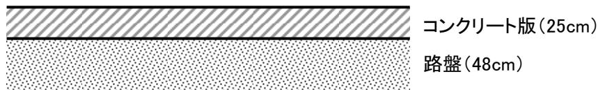
図 3-2-9 取付道路(1)の舗装構造
