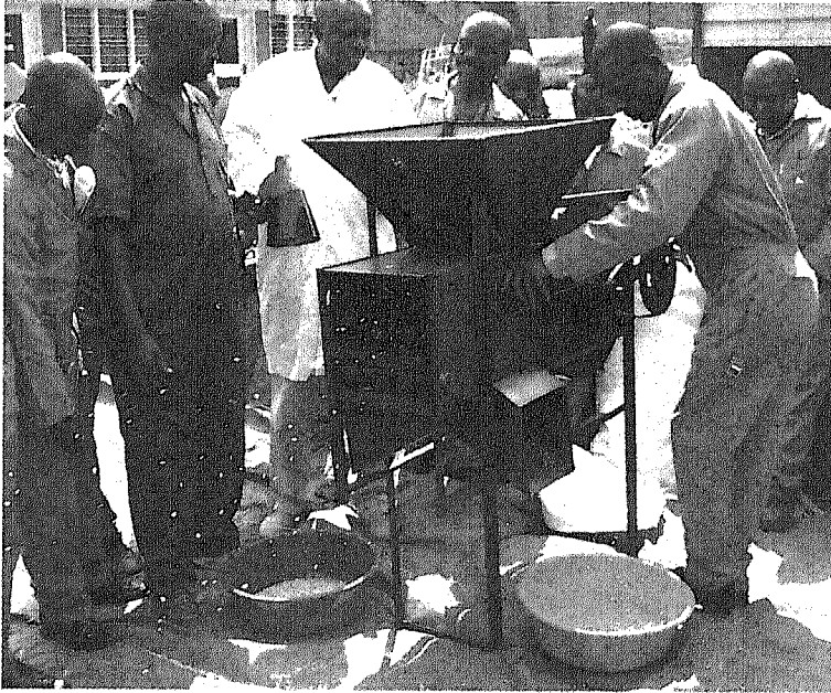
Los ingenieros están probando la criba toumi recién fabricada (Rwanda).
