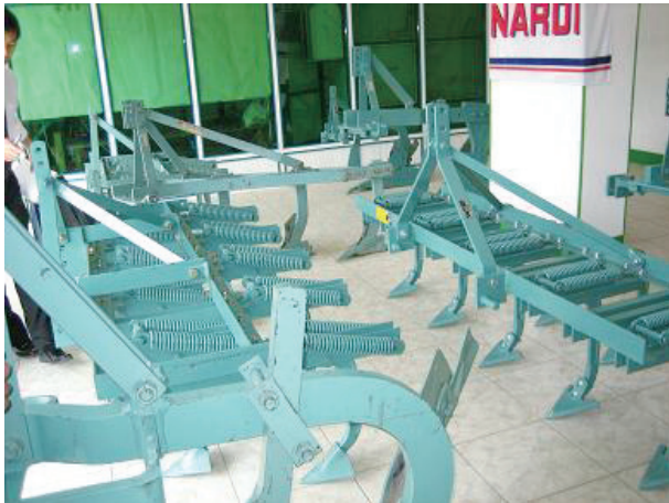
写真-9 農業資機材販売店で取り扱っている 2 種類のタインカルチベーター。<サナア市>
