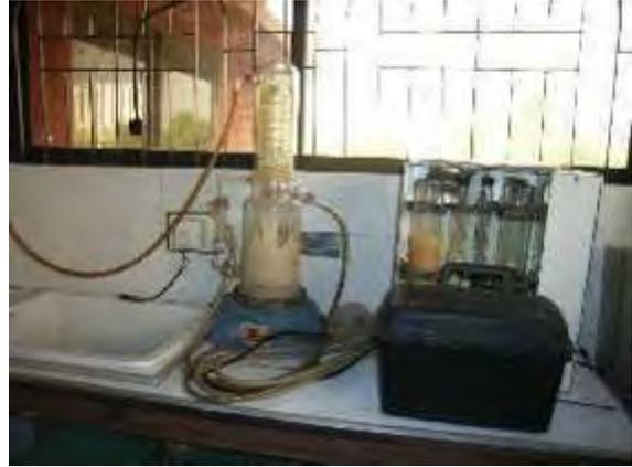
蒸留装置：スケールの付着が見られる。
