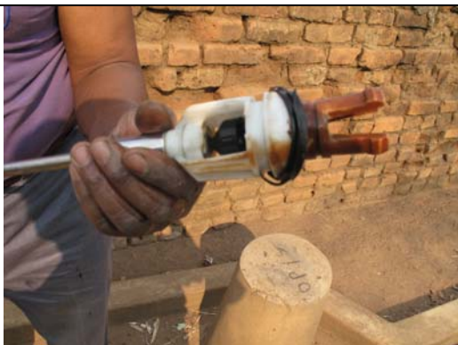
写真-11：揚水量の減少した井戸から取り出されたプランジャー（白色のプラスチック製ピストン）U-シール（中央の輪状ゴム）が磨耗し、正規の位置から外れている。
