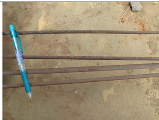
写真-10：腐食により設置時より細くなった軟鋼製ポンプロッド。稼動している井戸でも半分程度の径となっていて、折れる寸前のロッドが散見される。
