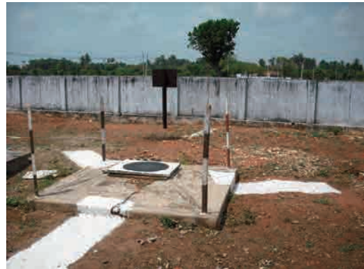
写真 3-3 設置した対空標識
