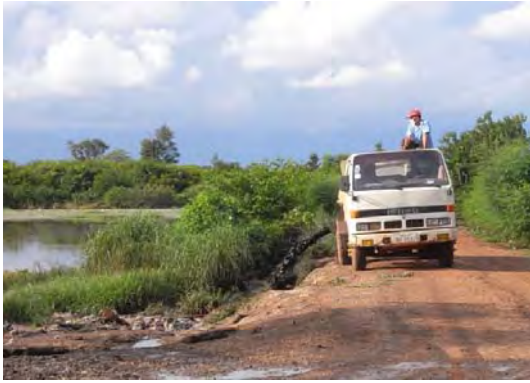
写真 6－11 処分場一画にある下水汚泥 処分池へ下水汚泥を放流する タンクローリー（ビエンチャン）
