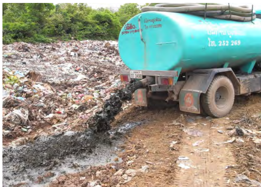
写真 6－7 ルアンパバン処分場 下水汚泥も固形廃棄物と一緒に処分される
