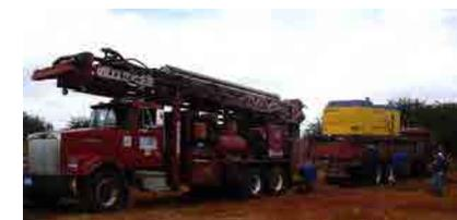
Se comprometió la utilización de una máquina perforadora a roto-percusión con el fin de expandir el diámetro de perforación y para llegar a los 200 metros de profundidad a alta velocidad en el sitio JICA01.
