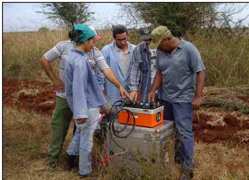
Este equipo de estudio EM (Método de Dominio de Tiempo) tiene un perfecto transmisor de energía de mediano rango para profundidades de sondeo, espesor y conductividad de las capas geológicas hasta los 500 metros, para una amplia variedad de aplicaciones como el mapeo de acuíferos y acuitardos, calidad de agua y
