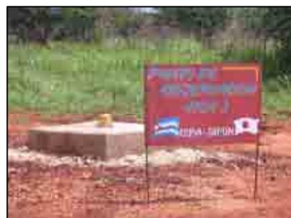
El nivel del agua subterránea es monitoreado de manera continua por medio de la instalación de medidores automáticos del nivel de agua que se indican en la foto.
