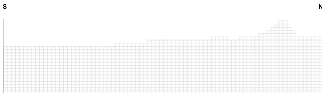
図 3-7: Y 方向の垂直モデル構造の例 (Column=78)
