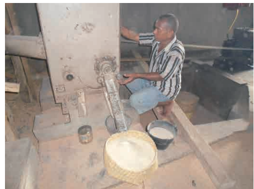
ブルト地区内にある民間精米所 （ワンパス式の日本製が使われている）
