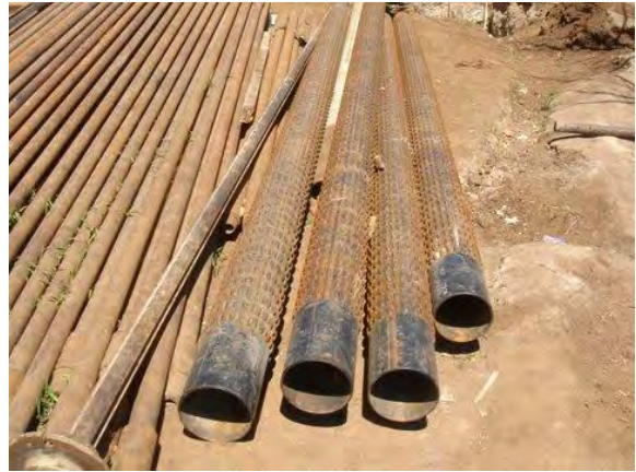
ケーシングパイプ（スクリーン）と掘削ロッド
