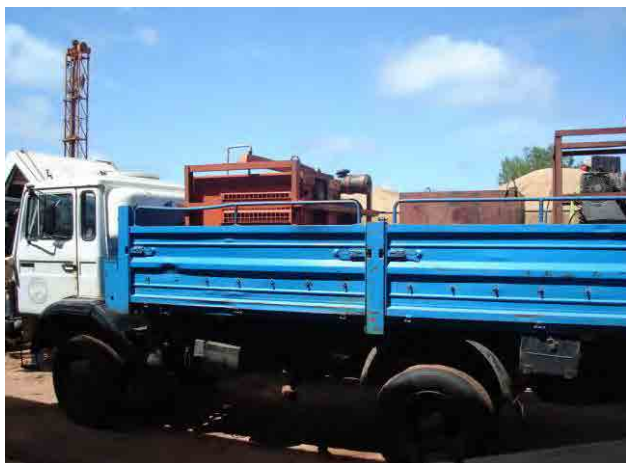
揚水試験用トラック（発電機、ポンプ等を搭載）
