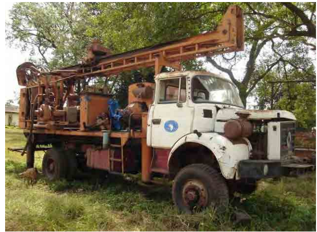
車両搭載型リグ: 故障中 (油圧系、エンジン)
