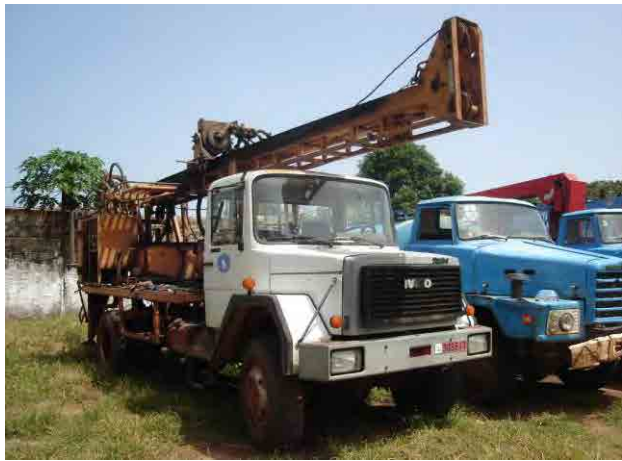
車両搭載型リグ: 整備が必要 (イギリス製)
