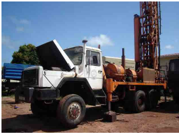
車両搭載型リグ：800m×200mmの掘さくが可能（ドイツ製） 雨期で掘さくを行わないため、整備中。
