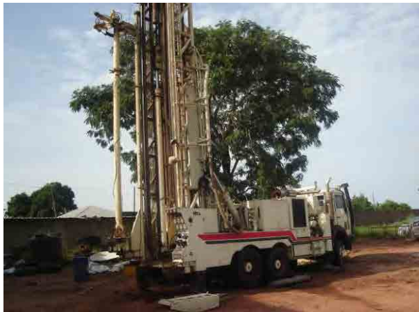
車両搭載型リグ： 700m×300mmの掘さくが可能（ドイツ製）
