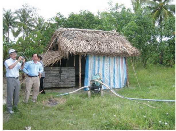
写真2 雨期に水田の水を排出するための自家用排水ポンプ。(カマウ市ビレッジ3)
