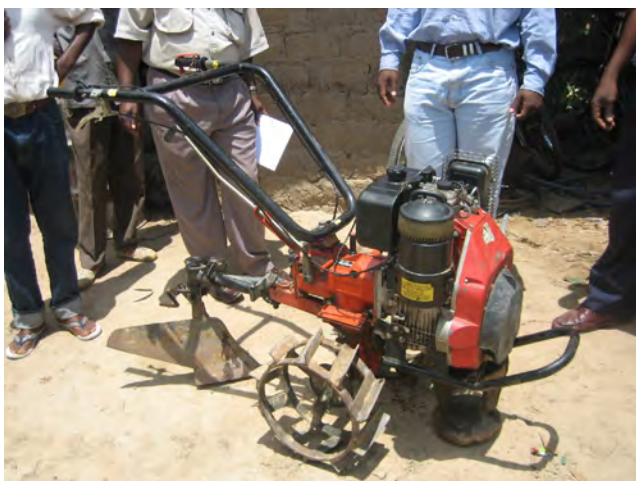
写真9 AMEPで導入した歩行用トラクター 利用者によると、メンテナンスも問題なく、使用法 も難しくないのので、作物栽培だけではなく、家庭菜 園にも重宝しているとの話であった。
