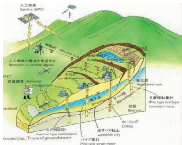
図3.5.1 地すべりモニタリング機器の種類
