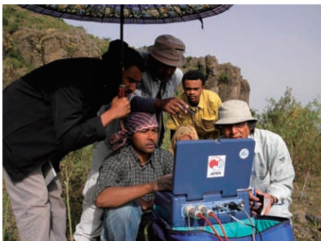
地すべり地帯での地震波探査
