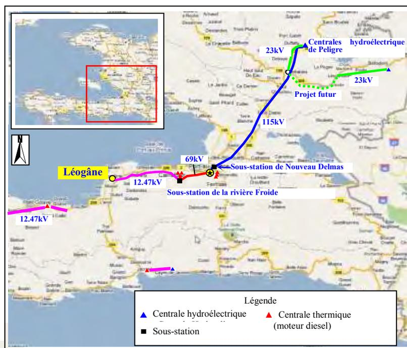
Figure B2-7 Route de ligne de distribution principale du réseau électrique de Port-au-Prince
