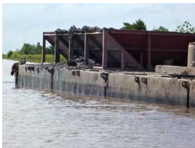
写真-3 用土収納槽付き台船
