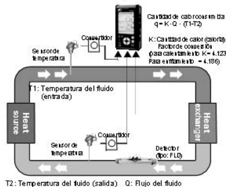
T2: Temperatura del fluido (salida) Q: Flujo del fluido
