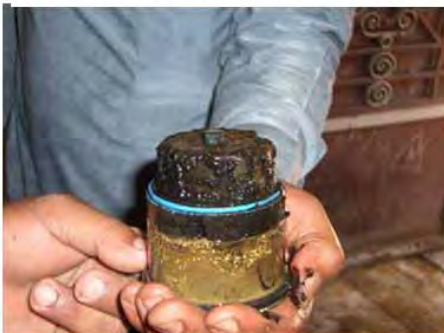
Limpiando un flujómetro
