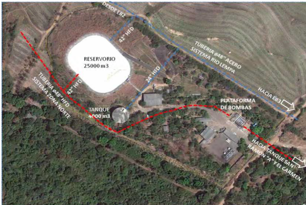
Imagen satelital de la Estación de Rebompeo “Central Nejapa” mostrando el reservorio de 25,000 m 3 de capacidad y el tanque de almacenamiento de 4,000 m 3 .
