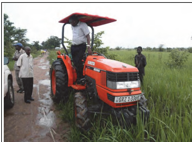
Kawambwa District Cooperative Union : カウンブラ農業協同組合 (Kawambwa District Cooperative Union) に 2009 年 12 月にトラクター1 台 (クボタ製、MX5000、50HP、4WD) が配布された。稼働する。
