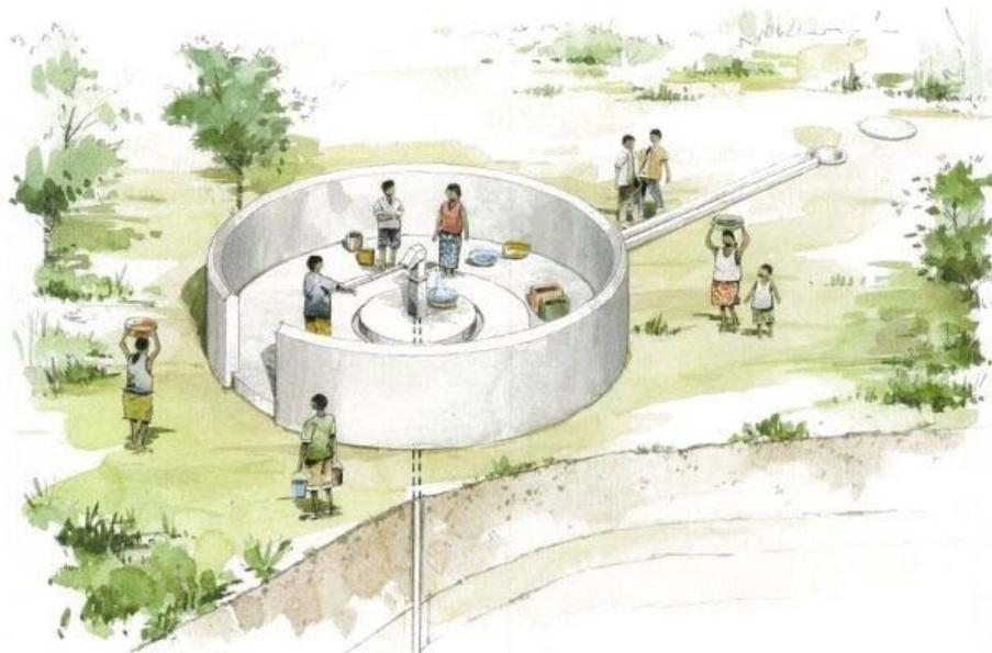
Ouvrage hydraulique équipé d'un forage avec pompe à motricité humaine (ouvrage PMH)
