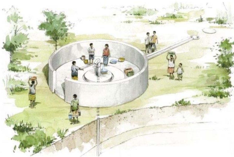
人力ポンプ付深井戸給水施設 (レベル1 施設)
