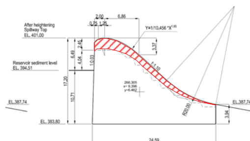
図-22 Sul ダム越流部の嵩上げ形状
