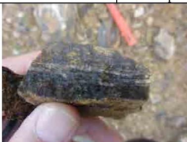
Estrutura de junta é N10W 70Wdip, levemente oblíqua à superfície do talude. Rocha dura de granulito.
