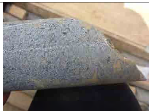
Perfuração do núcleo do leito rochoso, Granulito, rocha dura
