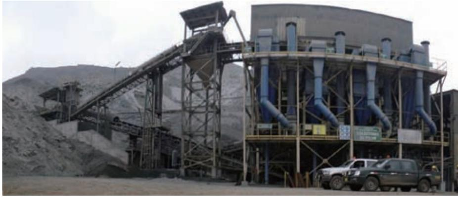
【Planta de Trituración Secundaria y Colector de Polvo】
