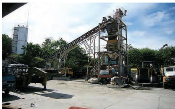
同左のコントラクターが有するコンクリートバッチングプラント：ウェットミックスであり、計量もオートマチックである。比較的高度なコンクリートの品質管理が期待できる。
