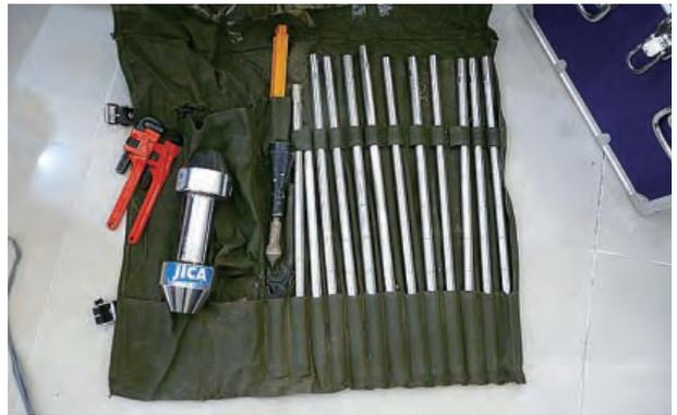
DPWH- リージョン VII での供与機材保管状況：（日本版）簡易動的貫入試験機。使用用途と評価方法については、理解できるまで説明・トレーニングする必要がある。
