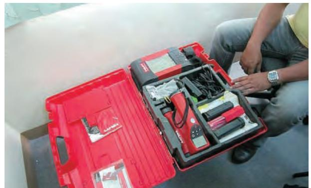
DPWH - リージョン XI での供与機材保管状況：リバーデテクター、鉄筋コンクリート構造の鉄筋位置を把握するのに使用する。
