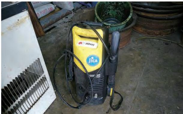
DPWH- リージョン VII (DEO) での供与機材保管状況：ウォータージェットクリーナー。四半期に1回程度の割合で、橋梁清掃等に用いられている。使用後の状態も良く、大事に使用されている。
