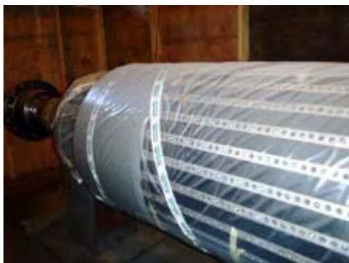
写真 4-18 発電機回転子
