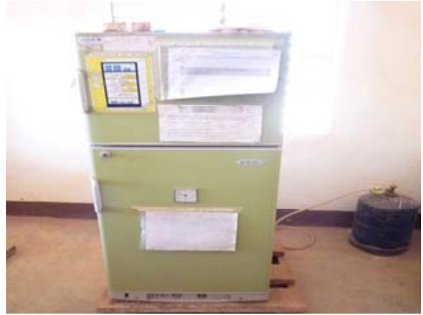
既存 CSPA ワクチン保冷用冷蔵庫
