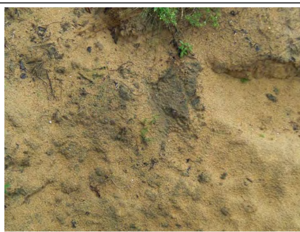
緩速ろ過池ろ過砂
