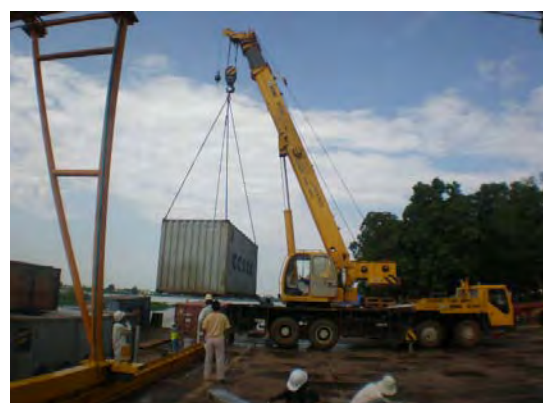
既存棧橋を使っでのコンテナ荷役
