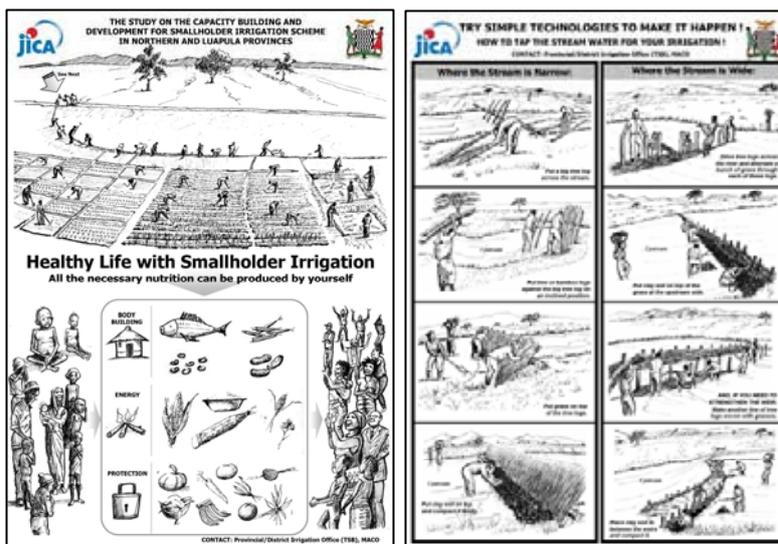
ポスターによる簡易堰灌漑普及：左側の導入ポスターが小規模灌漑と栄養改善をリンクさせている。また、右側は最も簡単な傾斜型簡易堰、1 重締切り型、2 重締切り型の簡易堰の建設方法を示している。
