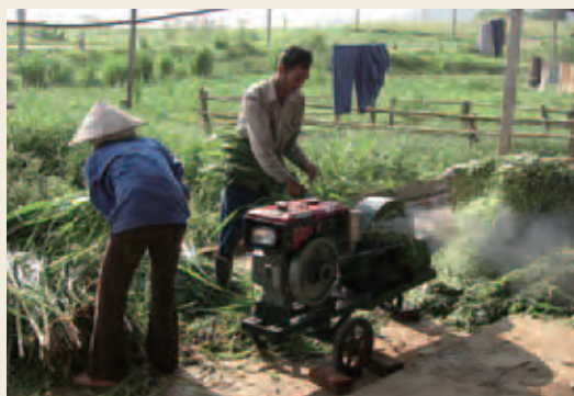
固い牧草を食べやすくするための牧草細断機を、地元の鍛冶屋に製作してもらったことで安価となり、一気に普及が進んだ(モデル農家での実証展示)
