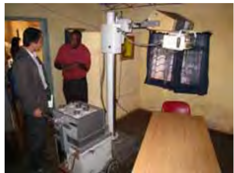
X線装置 敷地内にある民間業者の装置。旧式中古のモバイルX線装置を使用。センターは独自のX線装置を保有していない。
