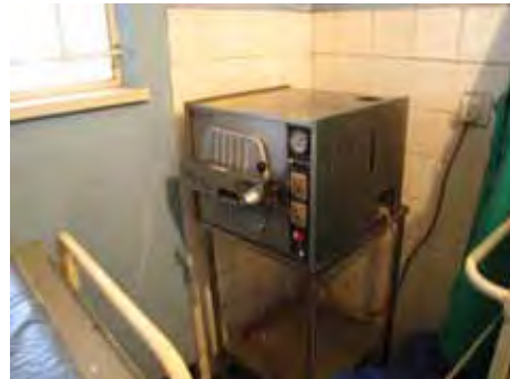
卓上式オートクレーブ 15年使用してきているが、老朽化のため故障が多く業務に支障が出ている。
