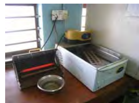
恒温槽 恒温槽(右)が故障しているため電気ストーブで水を温め使用している(左)。
