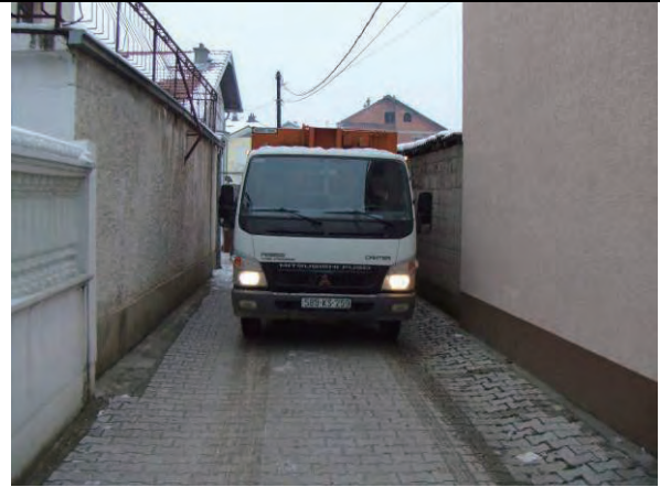
【プリズレン市の住宅地周辺道路】 後進により集積地へ進入する収集車。行き止まりの路地（幅3.5mほど）のため、後進によって進入する。距離は100～200mである。
