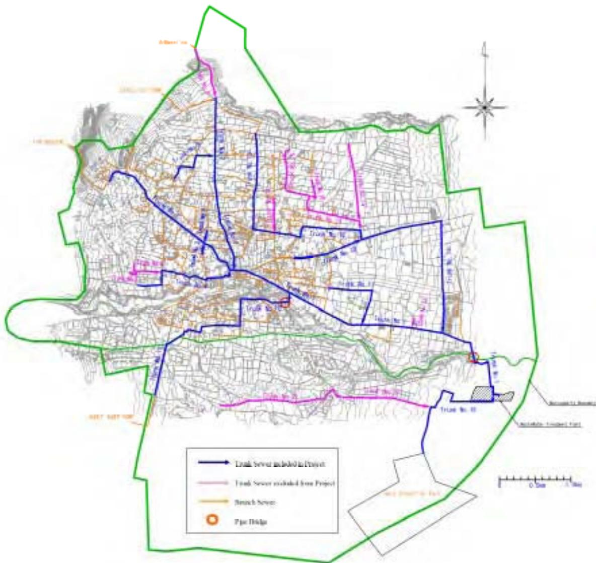
図 3-7 ジェリコ市内の汚水管渠配置図
