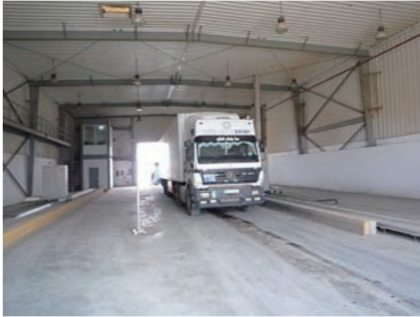
写真－19 移設可能型 \gamma 線検査機材：SAIC製。貨物車両用検査として使用。左奥に見える小屋の中で画像を分析する。検査終了後、税関シートに検査印が押印される。
