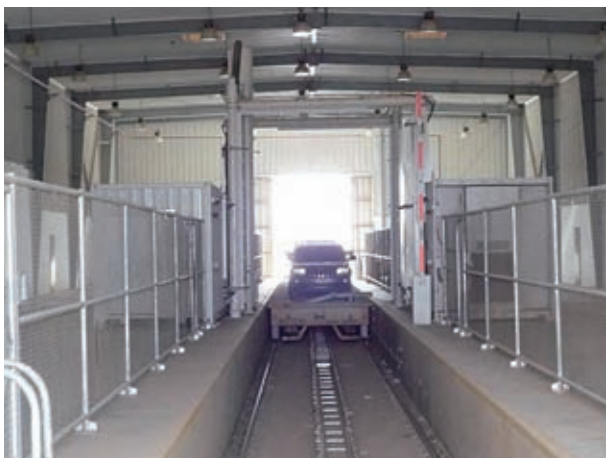
写真－17 移設可能型X線検査機材による検査の様子：移動型X線検査機材の故障により、現在は小型車両の検査を実施している。左側の小屋で画像解析を行う。
