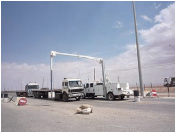
写真－15 移動式γ線検査機材：SAIC製。貨物車両用の検査を行う。一度に複数台の車両を検査する。
