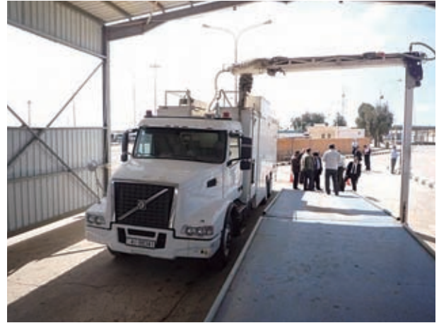
写真－20 移動型X線検査機材：AS&E製。小型車両用として使用している機材だが、現在修理中。
