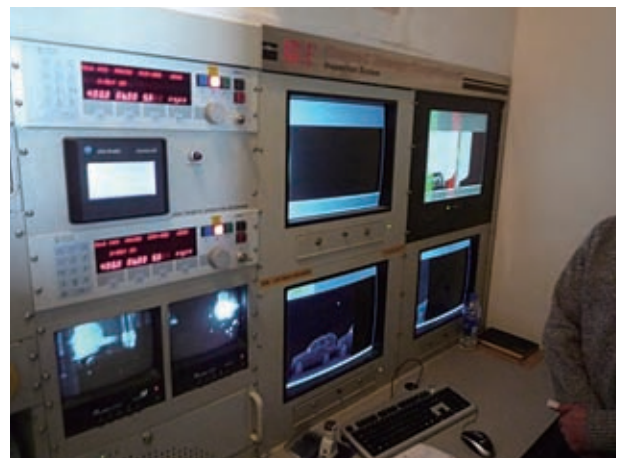
写真－18 移設可能型X線機材の画像：画像モニターの様子。中央下部のモニターに車両の陰影が写し出されている。
