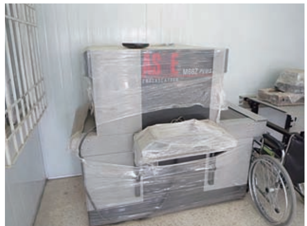
写真－24 手荷物用X線検査機材：AS & E製M66Z型の機材。非常に古く、現在は使われていない。
