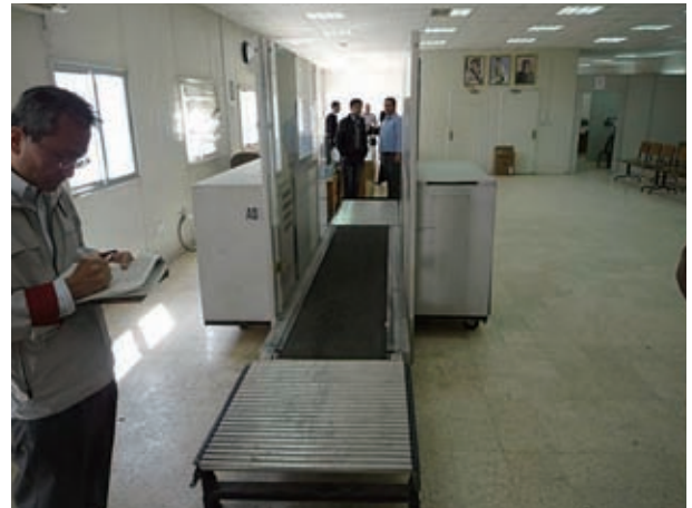
写真－22 手荷物用X線検査機材：AS&E製101ZZ型の機材。非常に古く画像が不鮮明なため、この奥のスペースですべての荷物のマニュアル検査を実施。同型のもう1台は故障して使われていない。
