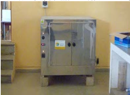
写真-13: 農村工学部水資源学科の所有するベルギー支援の試料乾燥装置。岩石試料作成等に共同で利用可能。
