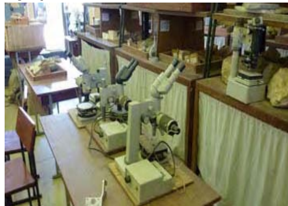
写真-6: 旧ソ連製の偏光顕微鏡。レンズなどの付属品が無く、故障しているため使用不可。
