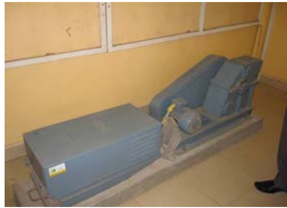
写真-8: 地質工学科専用で唯一使用可能な岩石粉砕機。岩石試料の粉碎に使用する。
