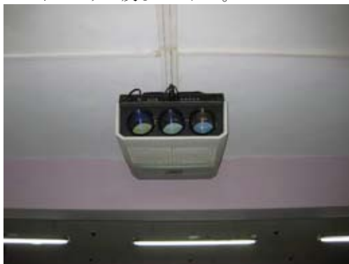
写真-8：PCデータの投影用データプロジェクター(3管式)。天井はコンクリートモルタル仕上げ。
