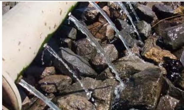
⑩-1 散水ノズルと礫層表面
