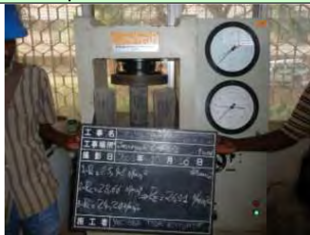
Step6. コンクリート圧縮強度試験
