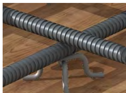
図-106 下段筋のスペーサー
