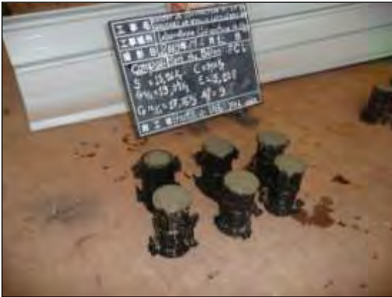
圧縮強度試験用供試体製造 イメージ
