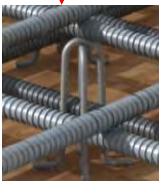
図-105 上段筋のスペーサー
