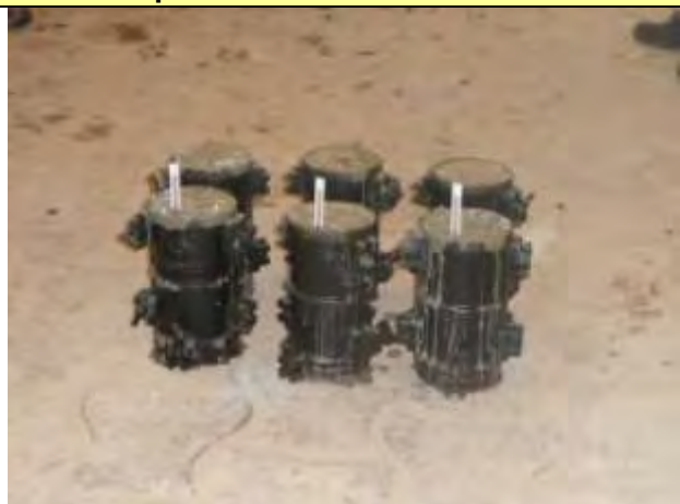
Step5. 圧縮強度試験のためのサンプリング (6 供試体)
