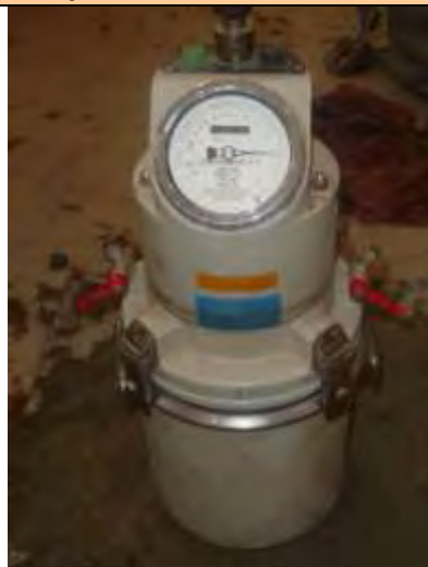
Step4. 測定器による空気量確認
