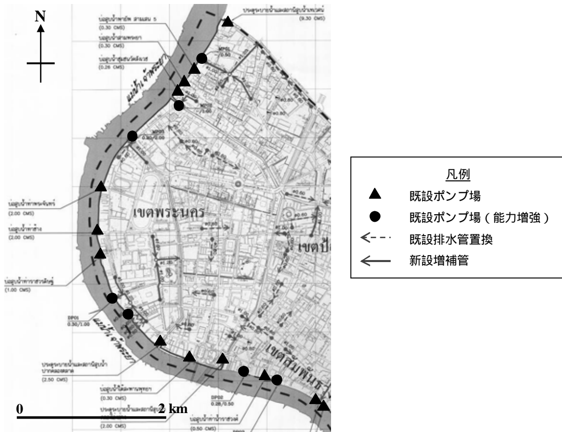
図 3.4.3 雨水排水ポンプ場、増補管計画事例（Phra Nakhon 区付近）
