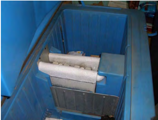
写真-7: 電気・灯油式冷蔵庫 中央にアイスパック冷却用の冷凍庫があるので、 冷凍庫は計画しない。
