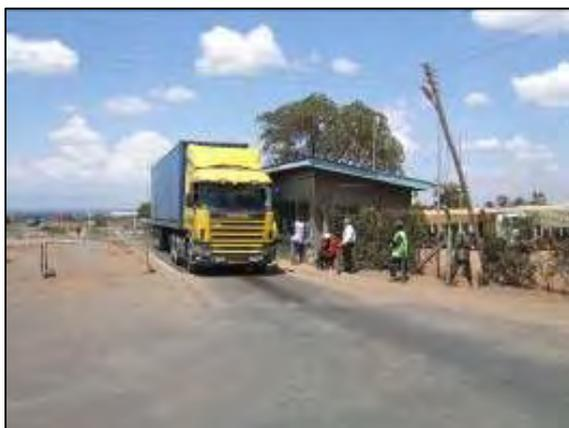
写真 3-1 大型車両の軸重の測定
